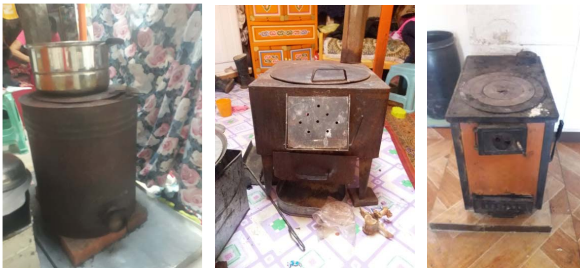
Зураг 1. 125 м 2 -аас доош талбайг халааж буй ахуйн хэрэглээний зуух
